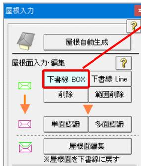
②「下書線 BOX」をクリックし、屋根面を BOX 入力（2 点クリック）します。下書線が緑線が表示されます。
